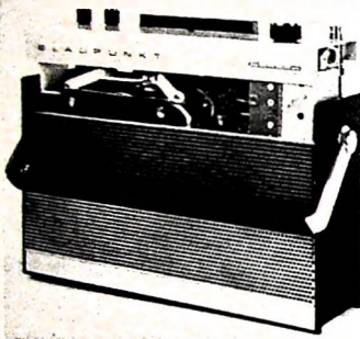
Bild 1. Reiseempfänger „Diva“ mit zum Teil herausgezogenem Chassis
